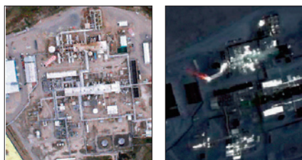
Dues imatges d'una planta de recuperació de sofre que està emetent gasos per la xemeneia, invisibles en el rang òptic, però que són identificables en l'espectre tèrmic.
