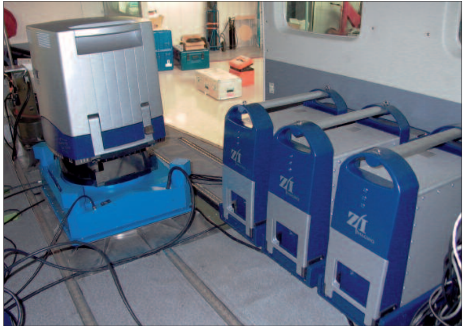
Càmera DMC001-026 instal·lada al Cessna Caravan 208 de l'ICC.
