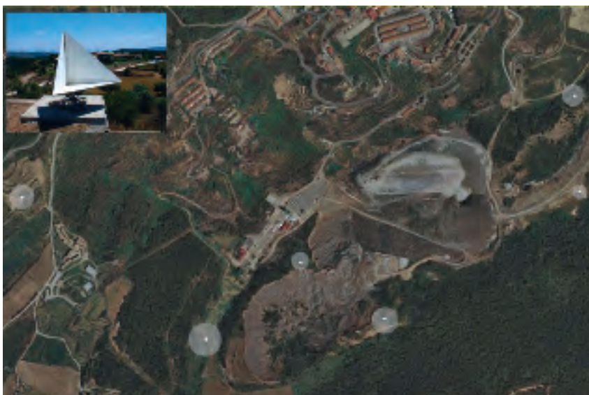
Ortofoto de la zona de la mina de sal a Cardona amb la intensitat del senyal radar dels tríedres.
