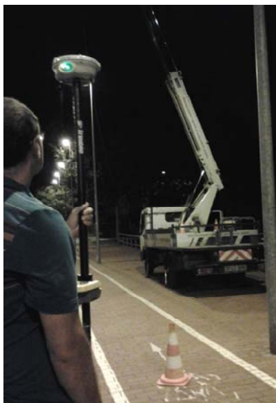
Imatge del treball de camp on s'aprecia la grua per a fer les mesures amb el luminancímetre i el recolzament de camp GPS d'alta precisió i la imatge de la classificació en \text{cd/m}^2 com a sortida del model ICC.
