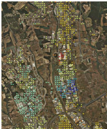
Subsidències a partir d'imatges ENVISAT i TerraSAR-X a Palau de Plegamans.
