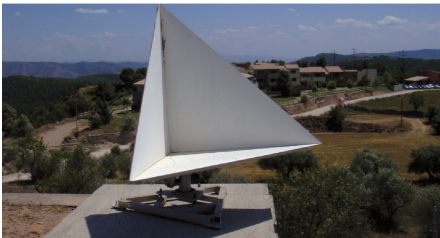
Imatge d'un dels "córners reflectors" instal·lats a Cardona (Bages) per a l'estudi de la subsidència
