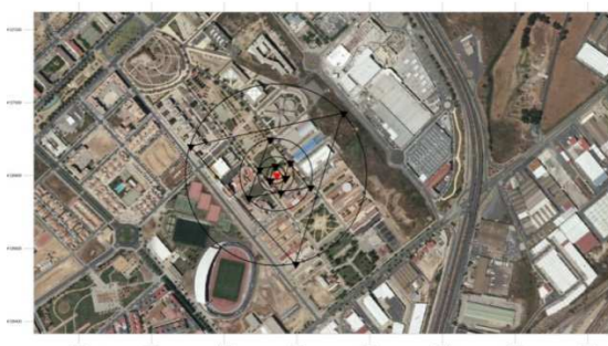
ALERTES_RIM. Ortofotomapa del recinte de la Universidad de Huelva on se superposa la geometria de l'array de soroll sísmic previst de dur a terme el 2016. En aquest emplaçament s'han planificat mesures de soroll sísmic en un sismòmetre central i en 4 anells concèntrics de tres sismòmetres cadascú i amb radis de 25, 50, 100 i 250 m respectivament.
