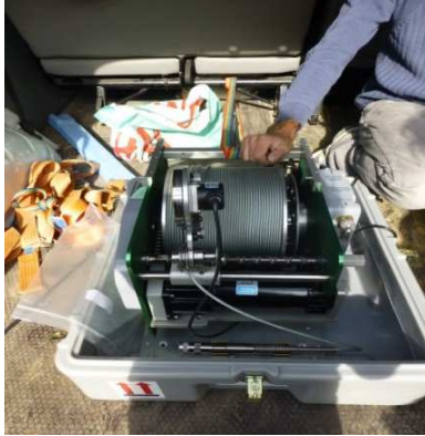
Instrumentació per a la testificació geofísica de sondatges renovada el 2015. Esquerra: cabestrant de 500 m de cable; dreta: sonda de mesura de temperatura i conductivitat del fluid present en el sondatge i de mesura de radiació gamma natural de la formació (sonda de punta blanca a la foto).
