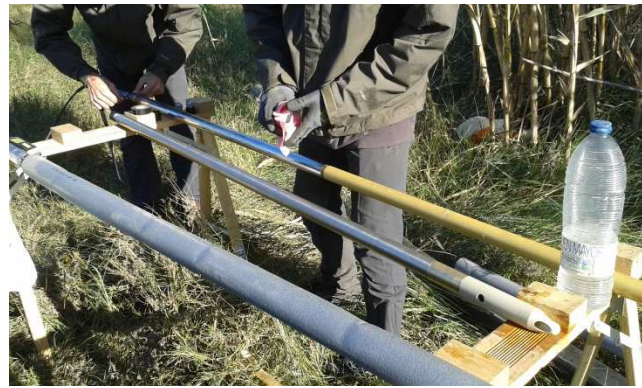
Instrumentació per a la testificació geofísica de sondatges renovada el 2015. Esquerra: cabestrant de 500 m de cable; dreta: sonda de mesura de temperatura i conductivitat del fluid present en el sondatge i de mesura de radiació gamma natural de la formació (sonda de punta blanca a la foto).
