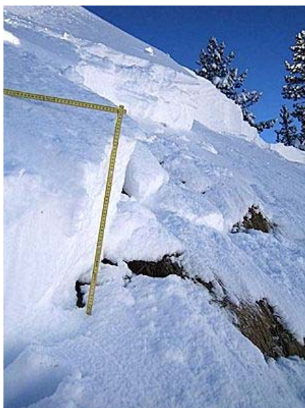
Aspecte de l'estructura del mantell en el contacte entre la neu ventada i la capa de baixa cohesió
