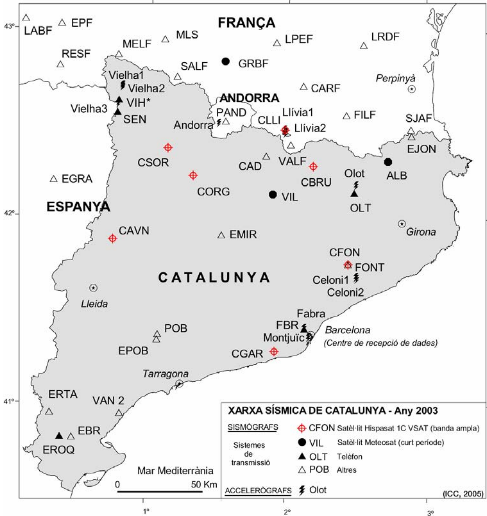
Figura 1. Situació de les estacions sísmiques, a l'any 2003, a Catalunya i regions veïnes. S'indiquen, amb diferents símbols, els diferents tipus d'equipaments. Les estacions sísmiques indicades amb un asterisc han funcionat una part de l'any.
