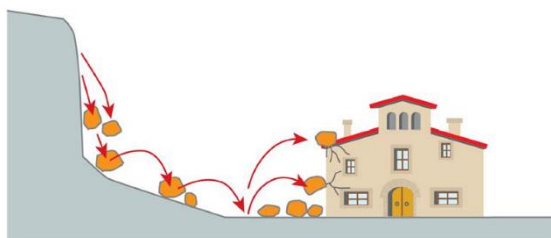
Figura 2: Despreniments i caiguda de roques.
