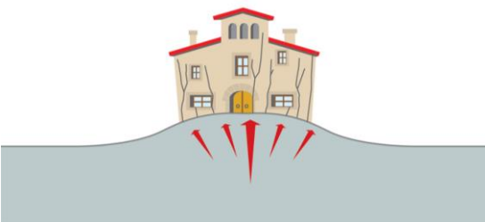
Figura 9: problemàtiques geotècniques (expansivitat).
